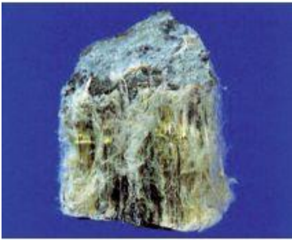
Bloc d'amiante (crysotile) montrant la nature fibreuse de ce minéral (d'après Corrin)
